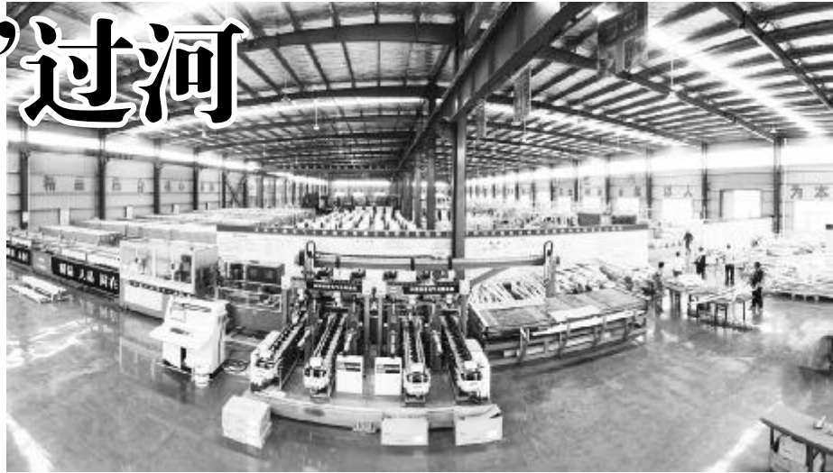
●图为 2022 年 10 月 8 日，中铁建电气化局南方公司郑万高铁湖北段项目部，智能化预配中心在预配智能化腕臂。
