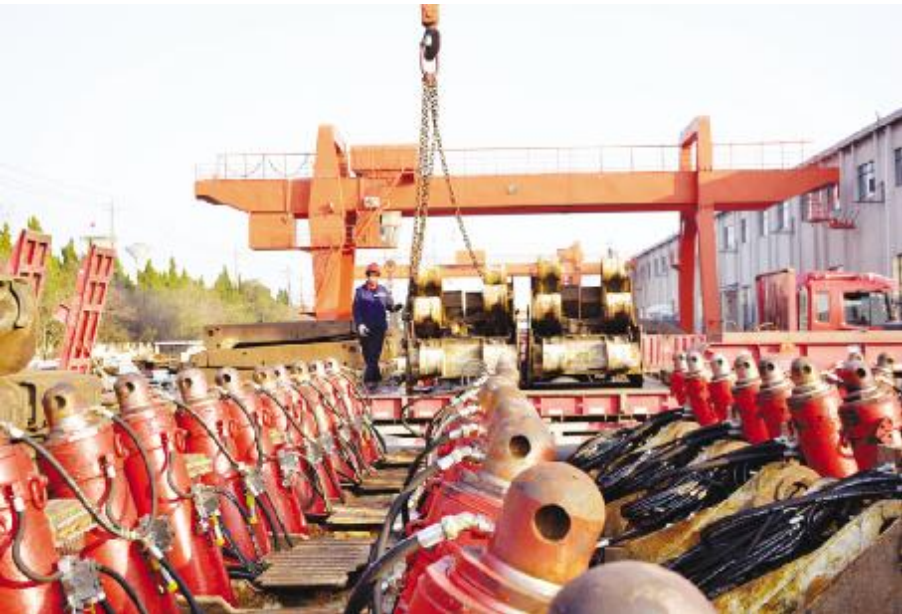
● 中煤新集设备维修公司液压支架检修班利用晴好天气，抓紧检修液压支架。
