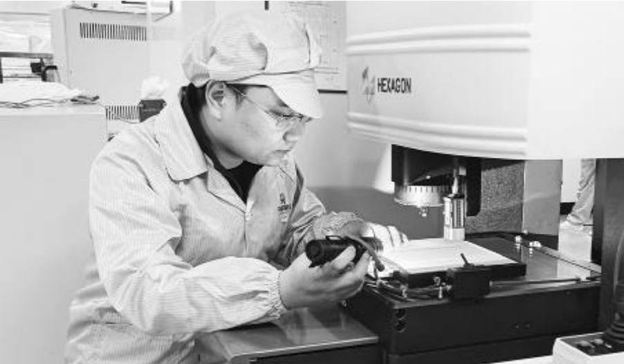
●胡秉权使用激光测厚仪测量传感器陶瓷膜片厚度，检查膜片形貌。 新华网发
