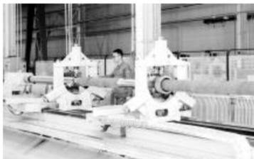
大的难题,钢中的有害元素如硫、磷等必须控制在极低水平,否则将严重影响钢管的性能和寿命;其次,超长钢管的直线度保证也是一个技术难题,由于钢管长度超过 17 米,在加工过程中很容易出现弯曲和变形,这不仅影响产品的外观质量,更可能导致设备无法正常运行。”“特钢事业部特钢研究院院长涂明金说道。
