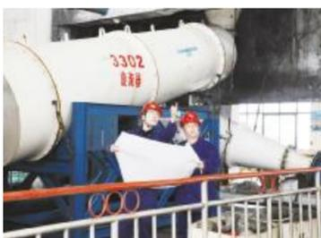
他们通过分析现场不同煤质,结合理论数据分析,不断调整三产品旋流器结构,模拟其内部流场,并对比不同煤样分选效果,优化三产品旋流器结构。通过数十次实验室模型试验、半工业配煤试验以及现场工业应用试验,最终实现设备改造及高精度分选的目标。
