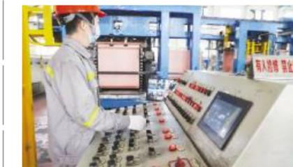
近年来,张家港联合铜业公司加大了对传统工艺装备的机械化、自动化和智能化升级改造力度,按照“自动化换人、机械化减人”的目标,先后投资近 3500 万元对 PC 电解和常规电解系统进行智能化升级改造,不仅减少一线艰苦岗位员工 43 人,劳动生产效率也较改造前提升 30% 以上。 杨学文 摄影报道
