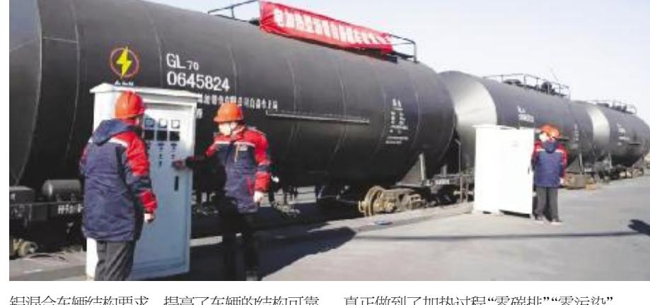
铝混合车辆结构要求,提高了车辆的结构可靠性。创新采用圆弧铝板顶盖、铝型材圆弧弯梁,实现小白重、高刚度的铝合金车顶结构。装用一体式集成缓冲器,极大地降低了车钩缓冲装置重量,同时缓解车辆运行时形成的纵向冲击及良好的曲线通过能力。
