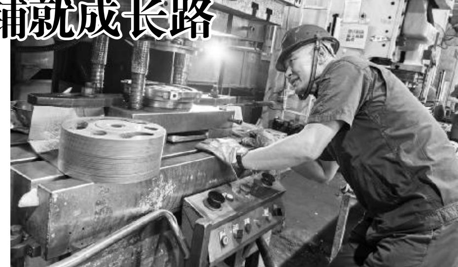
目。袁革带领团队经过一系列排查,终于找到产生径跳超差的根本原因是工装模具的问题,为此,袁革对焊接工装进行重新改进设计,调整后,经过4个月的生产验证,共计生产C14挠性飞轮产品6万多件,径跳废品率由3.7%降到0.01%,年度节创价值31万元。随后,袁革又将此项目横向展开到其他类似产品,年度为公司节约费用100多万元。
