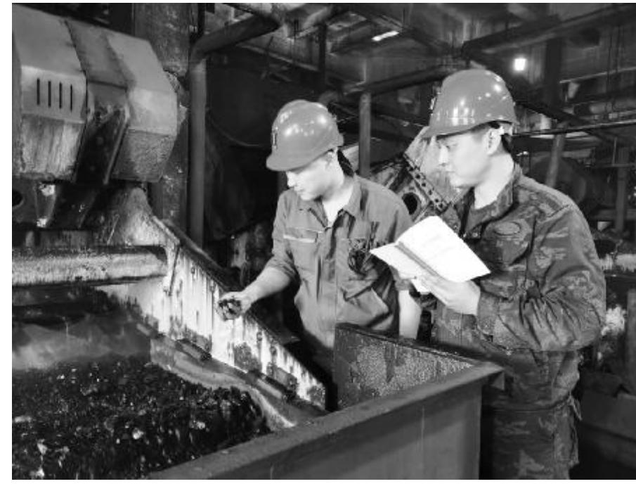
产线引进新式大锥角旋流器技术改造，完善分选工艺装备，实现中煤回收率提高近3%，有效地解决了唐家河煤矿1#煤入洗电煤热值低、回收率低和质量不稳定的难题，热值在原基础上提高400kcal/kg以上，水分从10%降到8%。普济生产线大力实施中煤泥独立回收系统技术改造，进一步降低浮选浓度，稳定中煤质量在3500kcal/kg以上，中煤回收率在原基础上提高1.2%。大力发挥超高压煤泥回收装备优势，煤泥产品自设备运行以来，水分一直维持在13.5%，热值均比以前提高了300kcal/kg，煤泥产品市场售价比过去增加65元/吨，单独销售的市场价比掺混电煤销售的利润更高。
