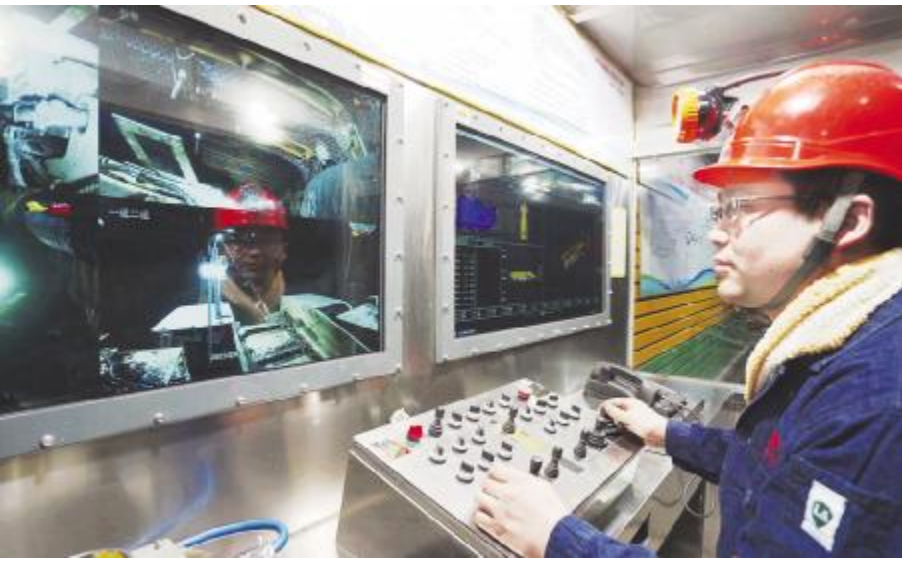
● 掘进机司机在集控室远程操作。
