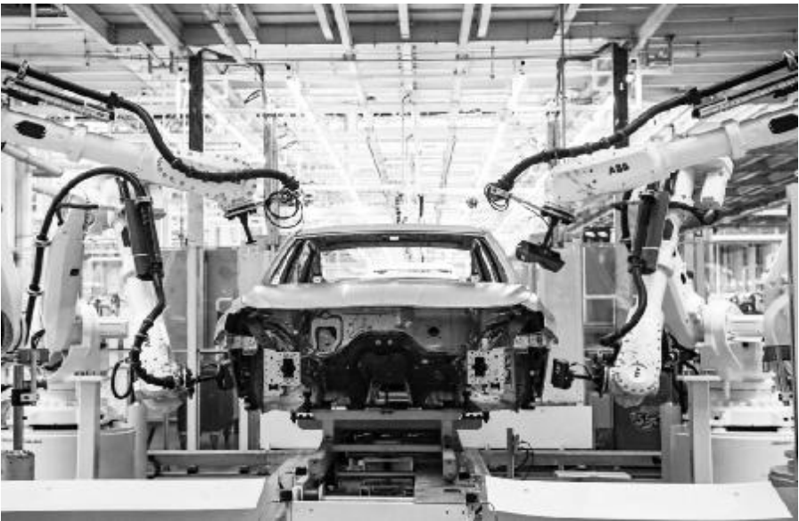
●位于吉林省长春市的一汽红旗繁荣工厂焊装车间内，焊装机器人在生产线上焊接车身。 颜麟蕴 摄
