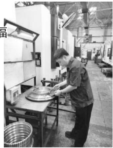
机相对、两组小倒角机相对、一大一小倒角机相对及两大一小倒角机(U型)四种布局方式,建成8条精益生产线,使操作者操作更加方便,转身即可操作另一台设备,减少步行时间,降低设备待机时间,提高生产效率10%以上。
