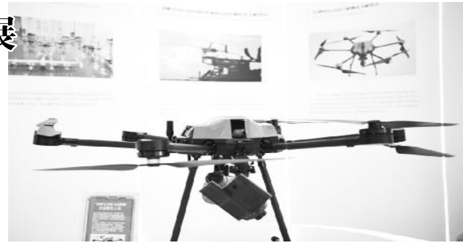
●这是在南京民用无人驾驶航空运行管理中心拍摄的飞鸿FG20M 5G网联多旋翼无人机。
