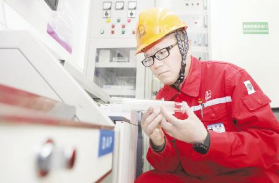
●郭涛手持针管将样气注入色谱仪。
