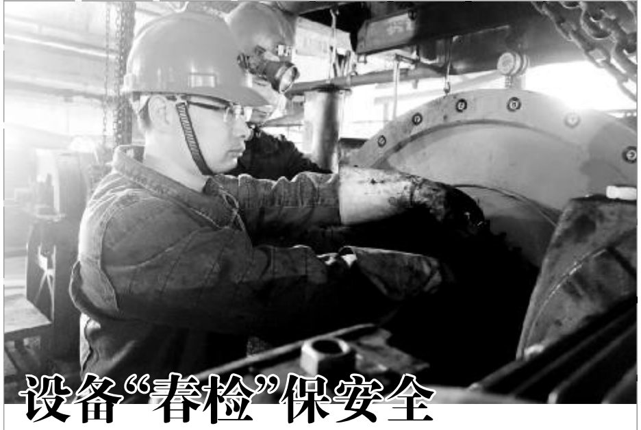
设备“春检”保安全 近期,安徽淮北矿业集团临涣选煤厂芦岭分厂机电车间抓住春季“黄金季”有利时机,合理排好检修计划,在各班组有序开展设备完好检修工作,掀起设备“春检”热潮,有效保障了设备安全生产无事故。 图为机修工正在更换碾石磁选机。 杨伟伟 摄影报道
