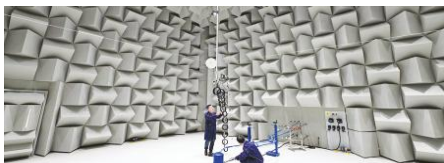
在丹佛斯全球制冷研发测试中心内拍摄的压缩机自动化共振性能检测测试室。孙凡越/摄
