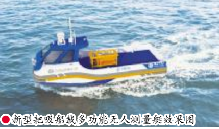
●新型耙吸船载多功能无人测量艇效果图
