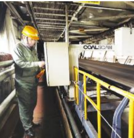
兴隆庄煤矿选煤中心加强对灰分仪的巡检维护,实现精准检测,保证产品质量。
