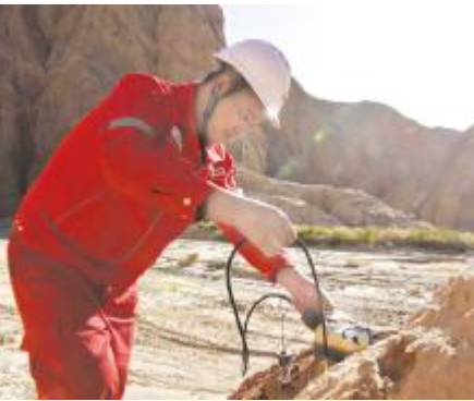
● 测试埋置拉力，验证检波器与地表的耦合情况。
