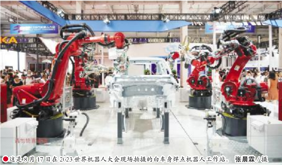
●这是8月17日在2023世界机器人大会现场拍摄的白车身焊点机器人工作站。 张晨霖/摄
