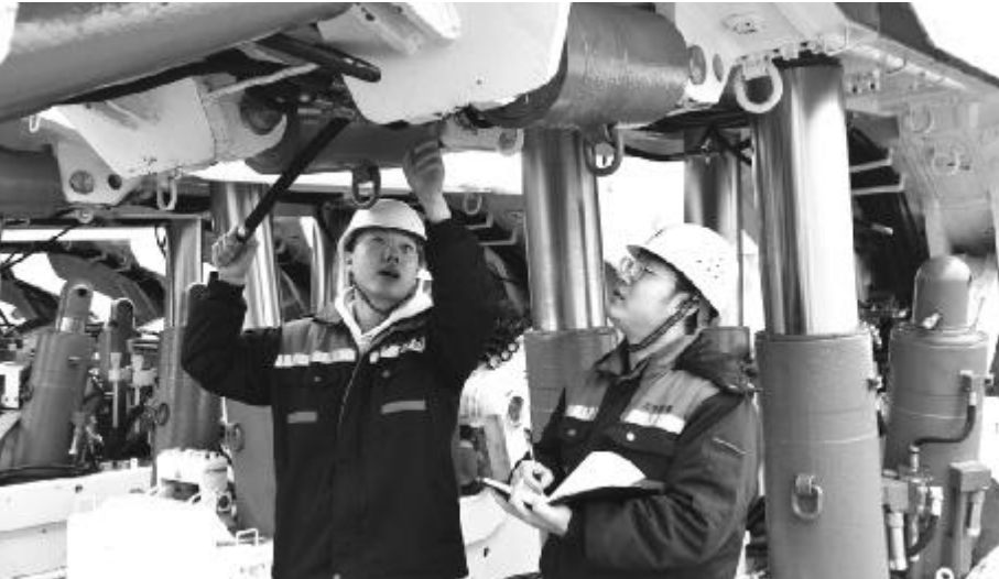
●图为方大公司质检员正在对支架维修质量进行检查。
