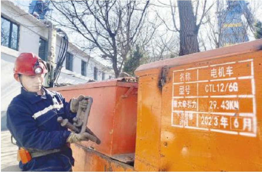
●图为王亮检查车辆连接装置。
