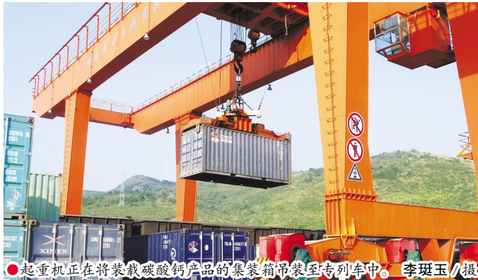
起重机正在将装载碳酸钙产品的集装箱吊装至专列车中。
