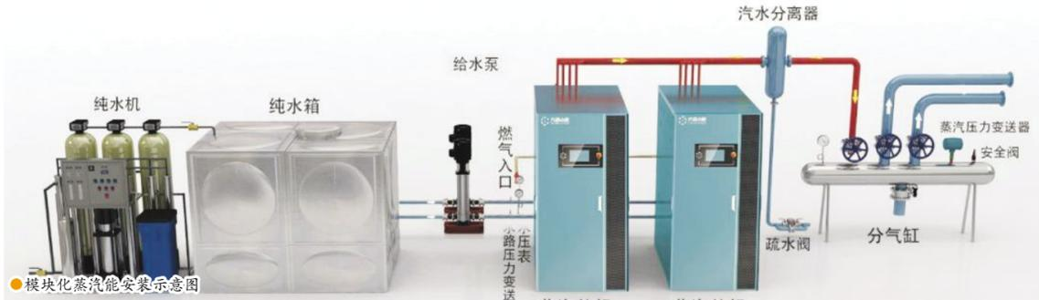
模块化蒸汽能安装示意图
