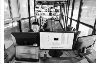
集团朱仙庄煤矿成功安装商 品煤外运自动装车系统,这 标志着该矿智能化矿井建设 又迈出坚实的一步。今年4 月份,该项目开始施工,采用 "物联网+"的理念,把绞车、 皮带机、给煤机、漏斗、空气 炮、平煤器、轨道衡等机电设 备和运销管理计量系统融为 一体,安装了16个视频监控 和语音播报系统,实现矿井 智能自动化装车外运。图为 职工正在操作自动化装车系
