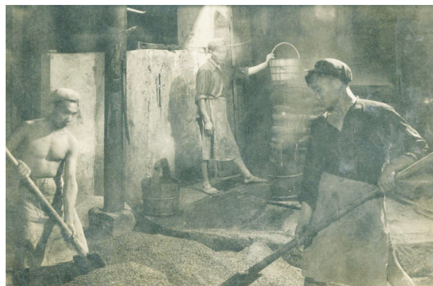
●20世纪50年代生产天锅烧水润粮工艺，老工人杨仕才（左）、张支荣（中）、罗得培（右）。
