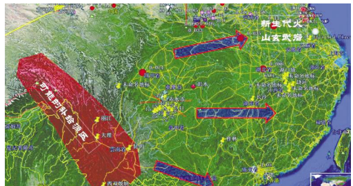
●高沟地下深循环水补给源示意图
