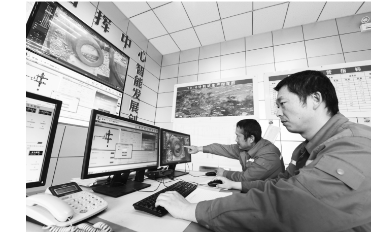
● 10-6 计转站值班员工正利用单井远程掺稀调控技术,远程调整 TP147CH2 井掺稀量,使调节时间由 4 小时缩短至 5 分钟,单井优化 6 人,年节约成本 39 万元。
