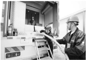
自主研发国网公司内首台隧道专用应急消防车。本次世园会供电保障加入的一项最新科技应用——应急消防车，这辆应急消防车采用的临界态二氧化碳(即气、液、固混合态)作为灭火介质，当隧道内发生火灾时，通过这边的喷放导管向隧道内喷射二氧化碳气体，迅速降低有限空间内氧气浓度，同时降低环境温度，实现快速灭火。我们已针对此次研发开展过应急演练，现场配置1辆消防车的情况下，对140米电缆隧道、2处火灾区的灭火时间约50秒，灭火范围广，用时短。除隧道灭火功能外，它还兼具通风、照明、视频通信等功能。在世园会供电保障期间，安排应急消防车另配备两名技术人员每
