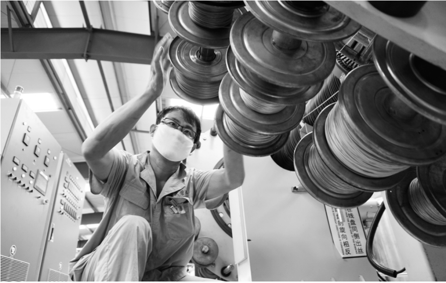
● 工人在更换生产线钢丝分盘
