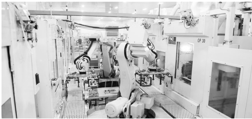
机器人在温州瑞安瑞明集团智能化托盘线上搬运物料。在这条生产线上,1个工人可操纵4台机器人,轻松完成相当于以前30个工人的工作。新华社记者 翁忻昉摄
