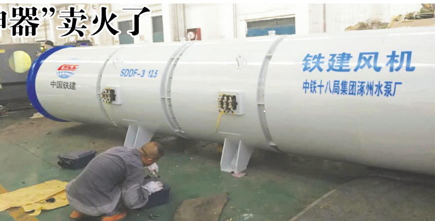
●SDDF型系列隧道轴流风机施工现场
