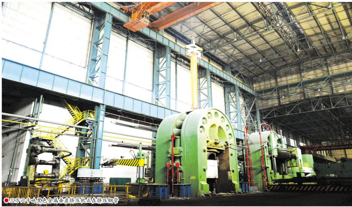
三万六千吨黑色金属垂直压机正在挤压钢管
