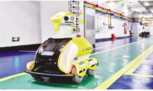
● 智能巡检机器人
