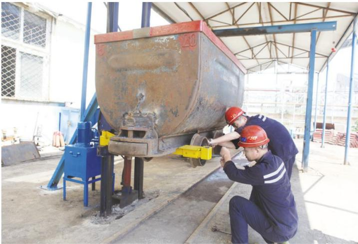
该托车器用报废的工字钢做为基础框架,不易变形,抗压性强,安全可靠。整个动力系统,有液压传动,具有稳定性高、操作简易和劳动强度小等特点。适用广泛,可安装在井下、地面各种环境,通过简易改造,也可适用到其他专业的升降作业或检修。
