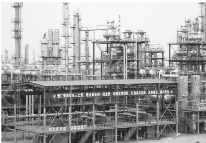
更是一种鞭策。在新旧动能转换现场转型升级过程中,甲乙酮厂群策群力,发动广大职工的集体智慧,狠抓现场,消除了现场的跑冒滴漏,我在mth装置循环泵,在VOC检测过程中,它的值是450,虽然小于500,但职工在巡检过程中,还是能闻到一阵阵的异味儿,通过干气密封改造之后,现场的异味基本没有了,voc的检测值达到了0这个标准。”
