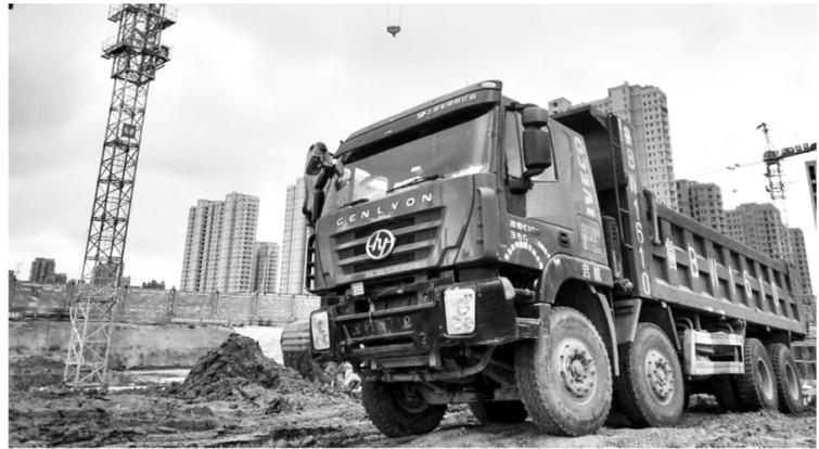
陡路滑,红岩金刚自卸车发动机还具有国内同类产品最大的发动机压缩制动能力——在目前国内同排量主流发动机制动功率为180kW-240kW的大环境下,上汽动力E系列发动机最大制动功率达到256kW。王师傅说,他在下坡或者减速时都会打开发动机制动,不仅可以提高下坡行驶速度,还能减少车辆的刹车磨损,减少制动距离,提高整车安全性能,并减少刹车片维护、更换次数,节约维修保养成本。
