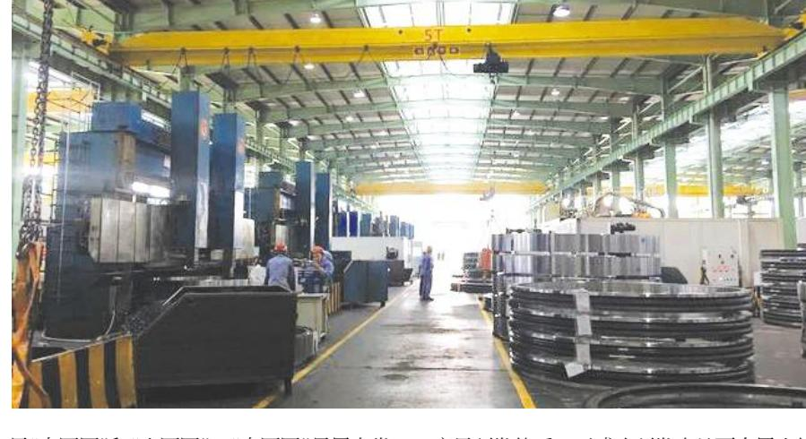
见“大圆圈”和“小圆圈”。“大圆圈”是风力发电变桨轴承的外圈,“小圆圈”是内圈。在组装之前,每一个圆圈都要经过“千锤百炼”才能成为一个合格的成品;再通过一百多道工序、两个多月的时间,才能被制造成为一套完整的风力发电轴承。
