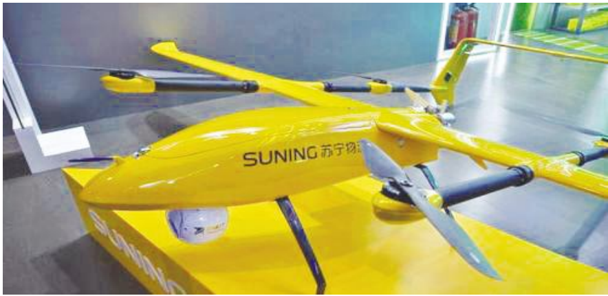
●亮相全球智慧物流峰会的苏宁物流油电混动垂直起降固定翼无人机
