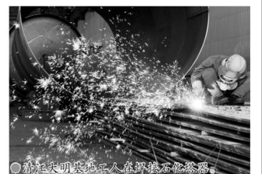
● 浙江大明基地工人正在焊接石化塔器。
