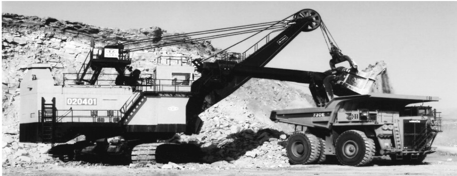
● 太重生产的 20 立方米挖掘机
