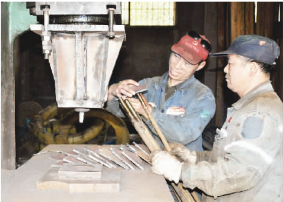
加工班班长范元超(左)同工友加工自制巷道支护锚盘
