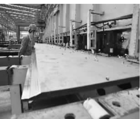
技术人员在检查化学船舶刨边加工质量。杨木军 摄
