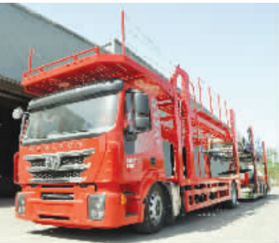
● 红岩杰狮中置轴轿运车是基于杰狮M100底盘打造而成,采用的是科索C9国四发动机,法士特十挡手动变速箱。
