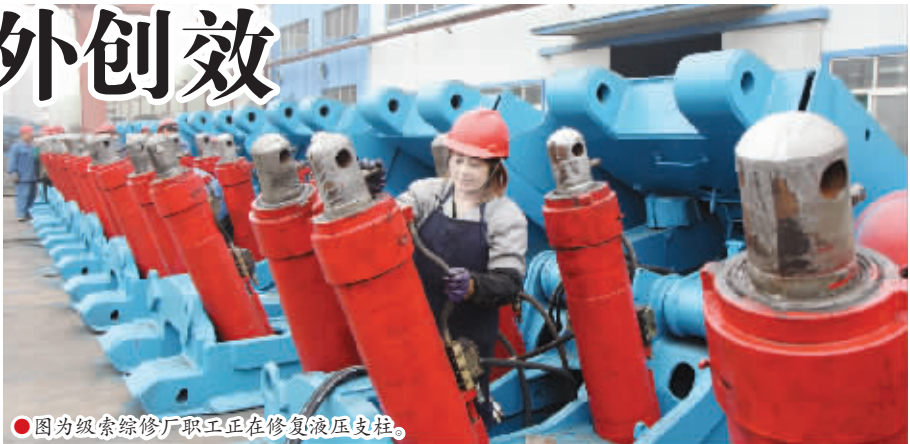
●图为级索综修厂职工正在修复液压支柱。
