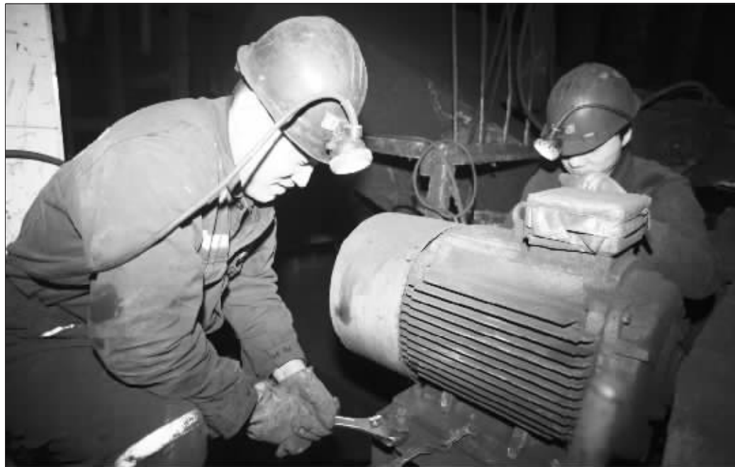
春节期间,山西省孝义市汾西矿业集团水峪煤业充分利用春节停产放假的时间,对井上井下各生产设备进行全面检修,全力消除各类故障,确保节后矿井安全生产。图为检修人员正在紧固电机地脚螺丝。
