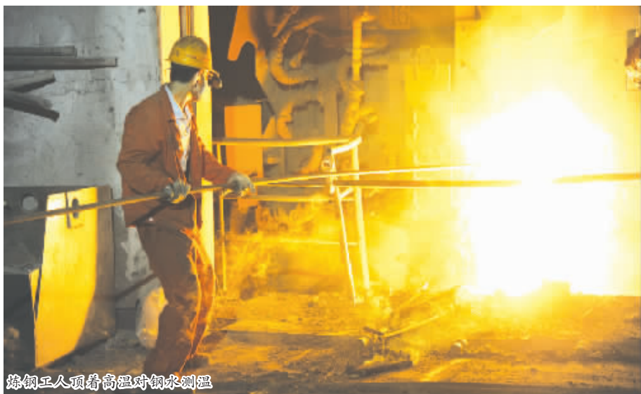
炼钢工人顶着高温对钢水测温
