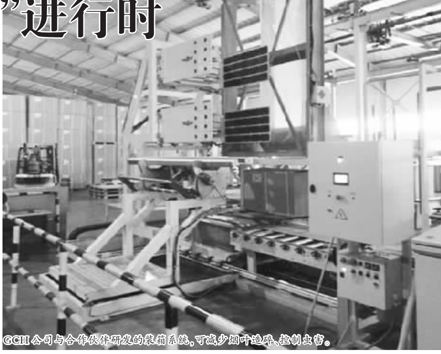
GCH 公司与合作伙伴研发的装箱系统,可减少烟叶造碎、控制虫害。
