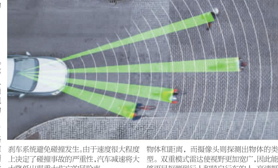
刹车系统避免碰撞发生。由于速度很大程度上决定了碰撞事故的严重性，汽车减速将大大降低出现重大伤亡的风险率。
