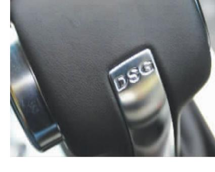
集中爆发。于是，2012年3月16日，大众发布声明称，配备7速双离合变速箱(DSG)车辆的客户，请到授权经销商进行软件升级。并表示，在特定条件下，尤其是外界温度和湿度较高，以及车辆在长时间停放以后，个别车辆的变速箱机电控制单元阀门上可能会出现结晶现象，由此导致发动机启动后无法挂挡，车辆无法行驶。通过软件免费升级服务，即可避免车辆出现上述现象。
