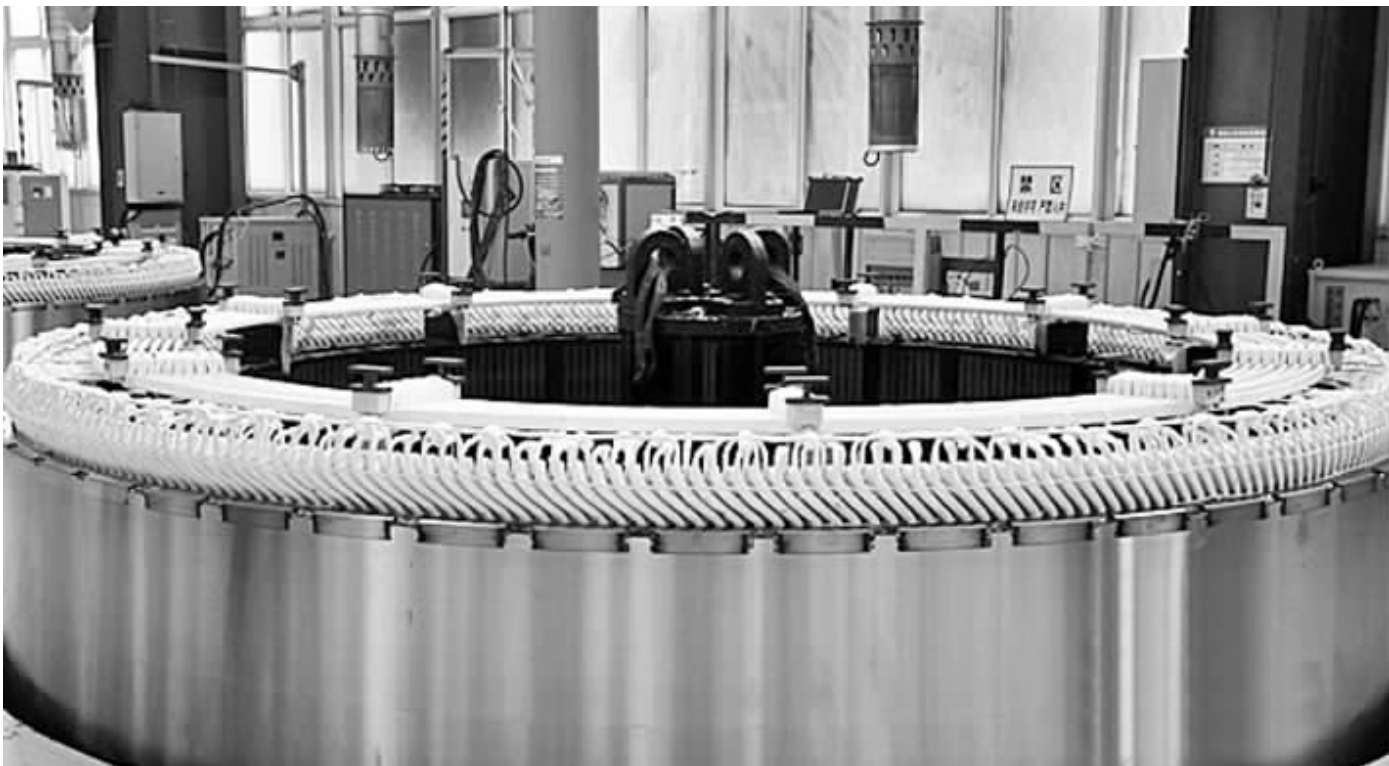
●由湘电集团生产的风机定子部分。
